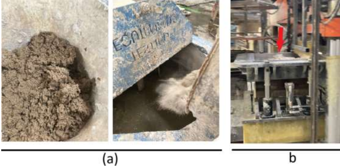
Resim 3. Test numunelerinin hazırlanmasına ait örnek görüntü (a) ve Test numunelerinin hazırlanmasına ait örnek görüntü (hazırlanan karışımın prese sürülmesi) (b).
