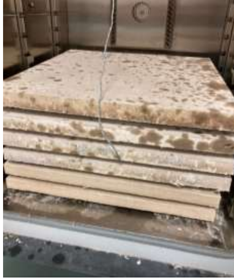
Resim 4. Test numunelerinin hazırlanmasına ait örnek görüntü (Etüvde kurutma işlemi). Elde edilen panellerin fiziksel, mekanik ve termal özellikleri belirlenerek FDM modifikasyonlu kenevir lifi katkısı değerlendirilmeye çalışılmıştır. Bu kapsamda panellerde su emme (a), yoğunluk (b), sertlik (c) ve eğilme dayanım testleri (d) gerçekleştirilmiştir (Resim 5). Enerji depolama performans ölçümleri ise Resim 6'da gösterilmiştir.
