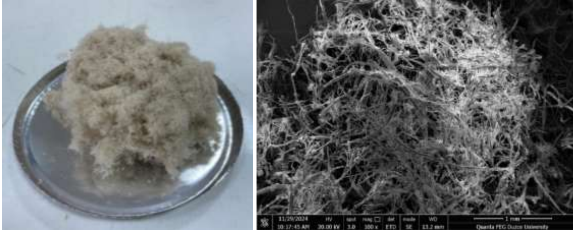
Şekil 3. Takviye malzemesi olarak kullanılan mikronize kenevir lifi
