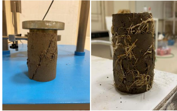
Şekil 2. a) 20 kPa, b) 100 kPa, c) 200 kPa çevre basıncı altında üç eksenli basınç deneyi uygulanan kenevir lifi katkılı numunelerin deney cihazından çıkan görüntüleri (Ahmad vd. (2019))
