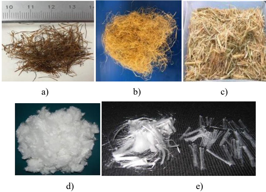
Şekil 1. a) Mısır ipeği lifleri, b) kenevir lifleri, c) Buğday samanı lifleri, d) Polyester elyaf, e) Polipropilen lif
